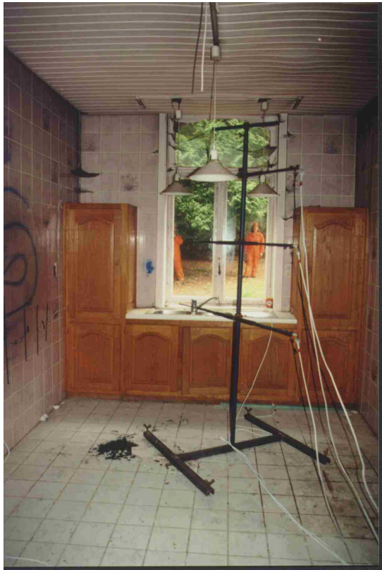
Photo 1 : Cuisine avant essai, avec l'arbre à TC
