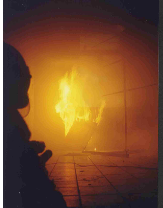
Photo 4 : La porte se détache
